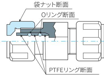
PTFE製のソロバン型シールはPTFEやPFAチューブを外径からかきつけて固定します。ガラス管やステンレス管の場合は樹脂製のチューブと違い、ソロバン型シールが食い込むことができないため、滑って抜けてしまうケースがあります。スリーシール式の継手は、FKM製Oリング2本をPTFE製リングで挟み込んで、硬い配管の外径を固定しますので、従来のPTFE製ソロバン型シールと比べ、滑り難く、しっかりと固定できます。
