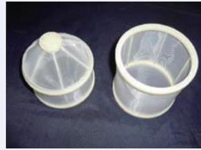
PFAメッシュ目開き140μのメッシュにABS樹脂で枠を作り接着剤で取り付けました。サイズは直径500mm高さ500mmぐらいの大きな加工品です。ABS樹脂の補強材を耐薬品性の塩ビ樹脂に変更することも可能です。
