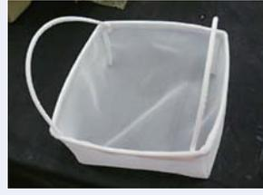
PFA60メッシュとPFA25メッシュを2重構造にし、硫酸フィルターと、硝酸フィルターの濾過に使用しています。PTFE製のφ4mmの丸棒を開口部分等の補強に使用し、材料が全てフッ素樹脂製で出来ているので、250℃の環境でも問題なく使用できます。
