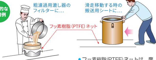
●フッ素樹脂 (PTFE) ネットは、耐薬品性・耐熱性に優れていますので、食品加工場で粗濾過用濾し器のフィルターとして利用されています。
