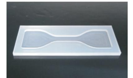
引っ張り試験用シリコン製型抜き治具
