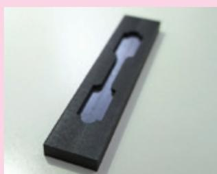
カーボン製ダンベル型抜き治具
