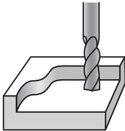
フライス加工とは、刃物を高速で回転させて樹脂を削り取り、目的の形状に仕上げる加工のことです。フライス盤という工作機械を使用し、平面や曲面、溝、穴あけといった幅広い加工に対応できます。
