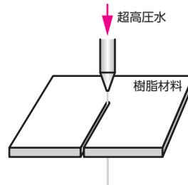
ウォータージェット加工とは、高密度な水を高圧かつ高速でノズルから噴射することで素材の切断や穴あけなどを行う加工方法です。抜き加工と違い型を必要とせず、またある程度の厚みまで対応可能で少量であればウォータージェット加工を選ばれることもあります。(PTFE でしたら6mm 程度の厚みまで加工可能です)
