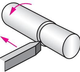
旋盤加工とは、回転させた材料に工具を当て樹脂を削り取り、目的の形状に仕上げる加工のことです。材料を回転させて加工を行うため、円筒形の材料を使用し、製品形状が丸に近い場合に使用されます。
