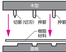
抜き加工とは、抜き型を使用して様々な形に型抜きをすることです。主に製作する製品の厚みが薄い場合で単純な形状の場合に使用されます。
